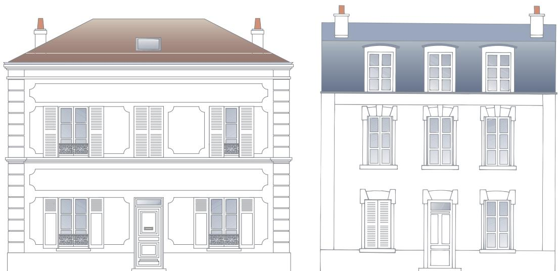
**Les matériaux** : les façades des maisons bourgeoises associent plusieurs matériaux avec une dominante en meulière utilisée en rocaillage ou en blocs taillés et jointoyés. Les décors (corniches, bandeaux, pilastres...) sont réalisés au plâtre et badigeonnés de blanc ou de teintes plus claires que les façades.
