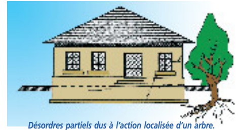
Désordres partiels dus à l'action localisée d'un arbre.
