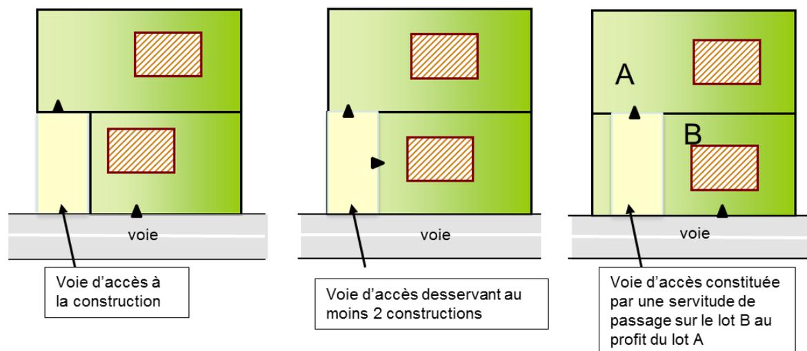
Chemin d'accès : chemin réalisé sur le terrain pour desservir les garages ou places de stationnement
